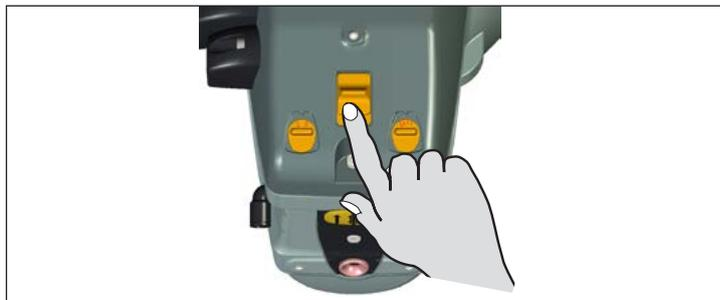
Wickelscheibe festhalten und unter Drücken des orangefarbenen Knopfes vorn am Spulenkörper drehen bis der Knopf spürbar einrastet. Wenn die Nullmarkierung an der Wickelscheibe mit dem Strich am Motorgehäuse fluchtet, beträgt die Separierung null.
