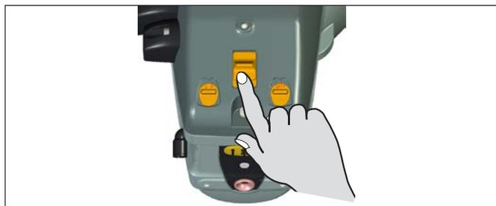
Saisir le disque d'enroulement et, tout en appuyant sur le bouton orange sur la partie antérieure du tambour d'enroulement, faire tourner le disque d'enroulement jusqu'à ce que le bouton s'engage. En alignant le repère du disque d'enroulement avec la ligne située sur le carter du moteur, on obtient la position de séparation "zéro".
