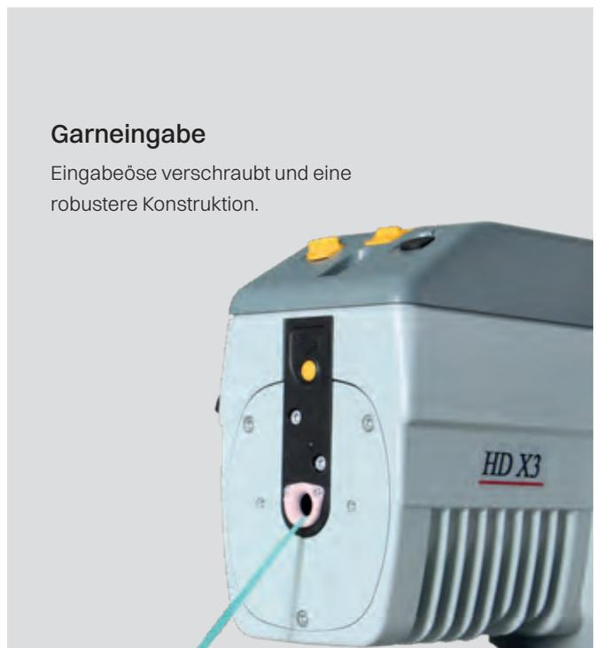
Dieser Schussfadenspeichertyp ist für anspruchsvolle Anwendungen mit Schussgarn aus dickem Monofilament, dickem Filament oder Jute vorgesehen, bei dem es auf die Abwickelgeschwindigkeit ankommt.
