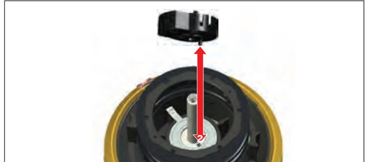
Entornillar los dos tornillos para fijar la parte en goma (3) y asegúrense de que sean fijados con la llave adecuada (Torx T10).
