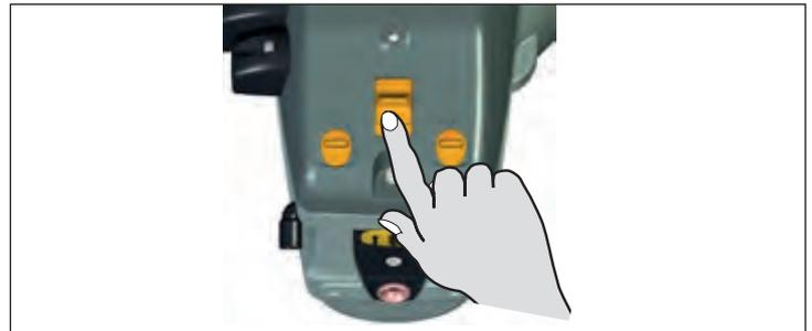
Sujetar el disco enrollador y, presionando al mismo tiempo el botón amarillo del tambor de enrollado, girar el disco hasta que el botón haga un clic. Alineando la flecha del disco enrollador con la marca del alimentador obtendremos la posición cero de separación de espiras.
