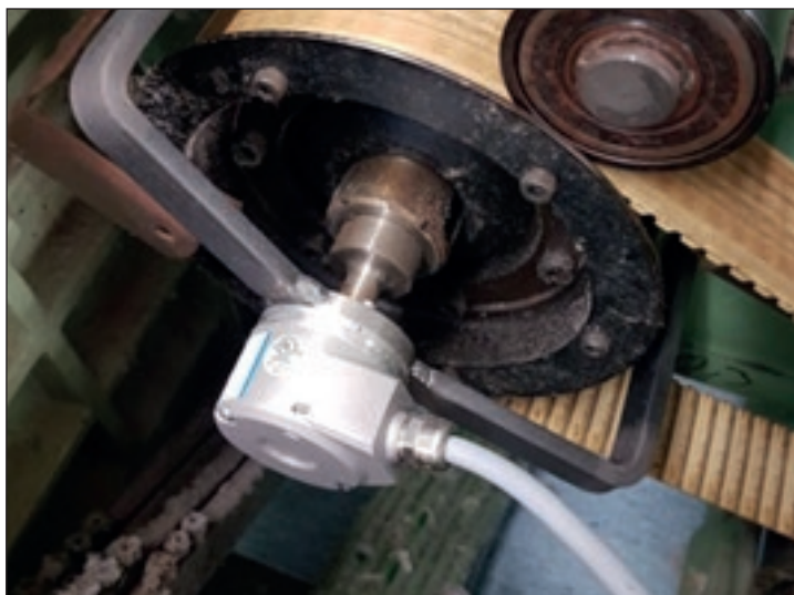
Příklad kodéru instalovaného na tkacím stroji
